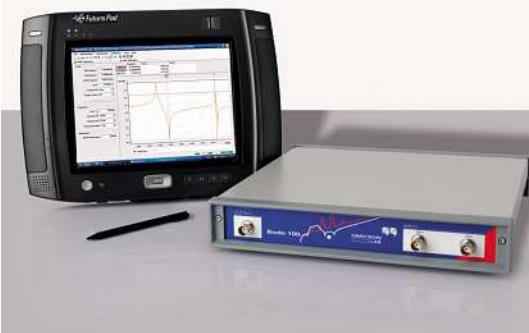
Vektor-Netzwerkanalysator Bode 100 (1 Hz – 40 MHz) und Future.Pad Tablet PC von www.ibd-aut.com
