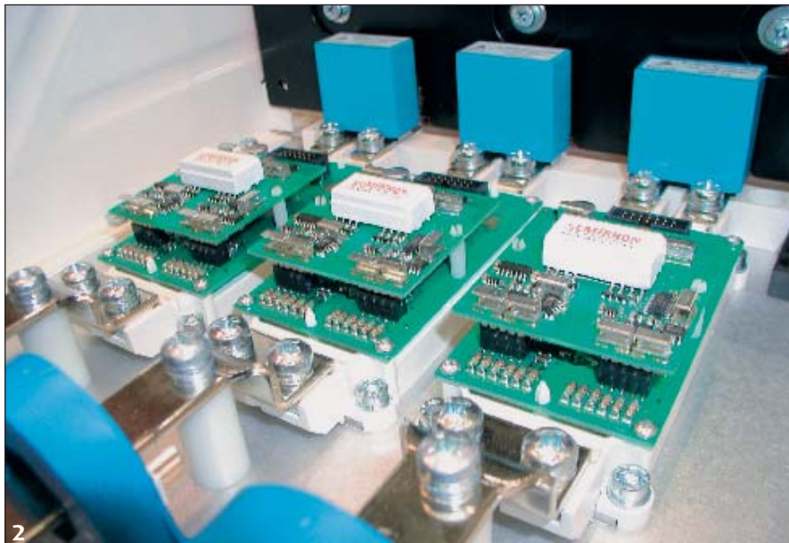
1: SEMiX-IGBT-Plattformen haben extrem flache modulare Power-Stacks. 2: Umrichter mit Semix- und SKYPER-Treiberkernen
