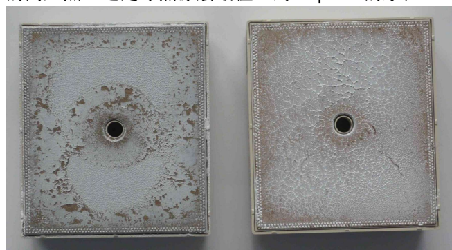
图 3：糟糕的（左）和最佳的（右）模块导热涂层处理
